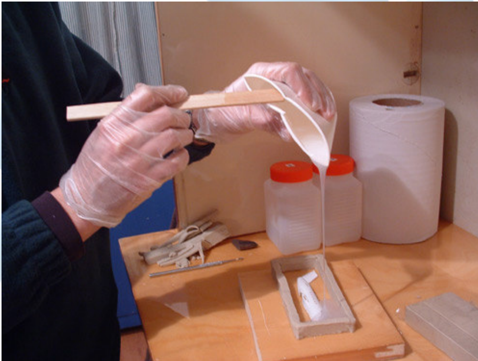
rubber altijd vanuit hoek gieten, zodat er zo min mogelijk luchtbubbel ontstaan
